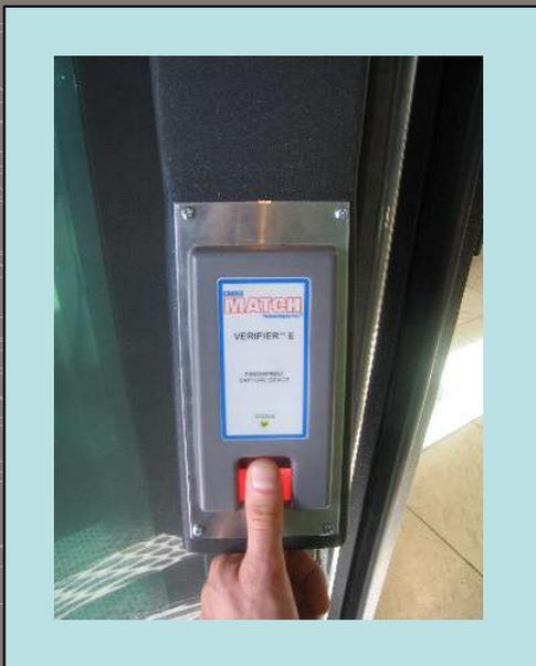
**Un sistema biometrico è un dispositivo automatico in grado di verificare l'identità di un utente sulla base di una sua caratteristica fisiologica (impronte digitali, mano, volto, iride, retina, ...) o comportamentale (voce, firma, stile di battitura, ecc.).**
